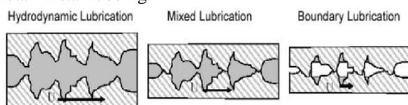
Fig. 6 : Modes of ring lubrication
