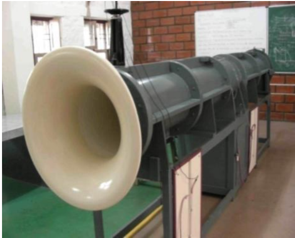
Fig: 2 Ducted Axial Fan Rig
