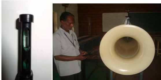
Fig: 4 Hot Wire Sensor Probe
