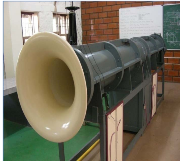
Fig: 2 Ducted Axial Fan Rig
