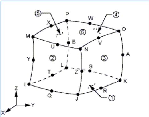
Fig. 8 : Solid 95 Geometry
