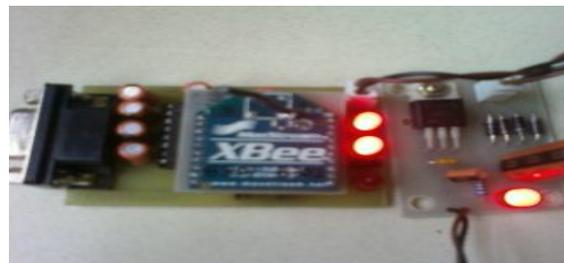
Figure6. Zigbee module
